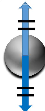
空気抵抗力は一般に抗力であるから、抗力  $D$  [N] について考える。 $D$  とは、物体が流れの方向の成分から受ける力のことを言う。自由落下における  $D$  は空気が鉛直方向に流れる際の物体が受ける力である。 $D$  は以下の式で表される（ニュートンの抵抗法則）。
